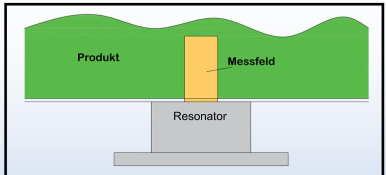
Aufgrund der Abstandsabhängigkeit des Sensors muss der Sensor so nah wie möglich am Produkt installiert werden. Der Messwert ist als %H<sub>2</sub>O verfügbar.
