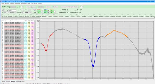
Die Probe wird mit einer speziell entwickelten Halogenlampe bestrahlt. Die dadurch entstehende diffuse Reflexion (diese enthält die nötigen Informationen über die Bestandteile) wird über ein Glasfaserkabel zum Spektrometer übertragen. Hier wird das gemessene Spektrum in 256 Stützpunkte geteilt.
