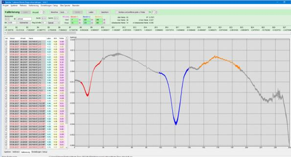
Le produit sera illuminé avec une lampe halogène spécialement développée. La réflexion diffuse résultante est transmise par fibre optique au spectromètre. Le spectromètre a divisé les spectres en 256 points.
