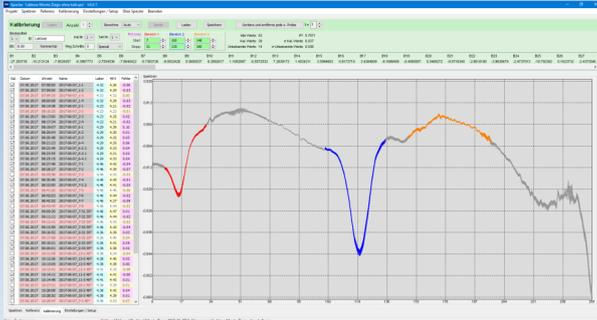
Le produit sera irradié avec une lampe halogène spécialement développée. La réflexion diffuse résultante (contient les informations nécessaires des constituants) est transmise par la fibre optique au spectromètre. Le spectromètre divise le spectre en 256 points .
