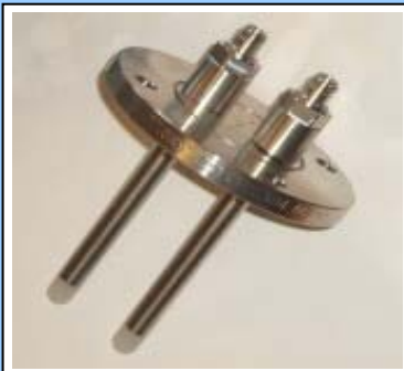
integrierte Stabsensoren Normflansch DN65 / PN6 Sensorabstand 55mm Eintauchtiefe 195mm
